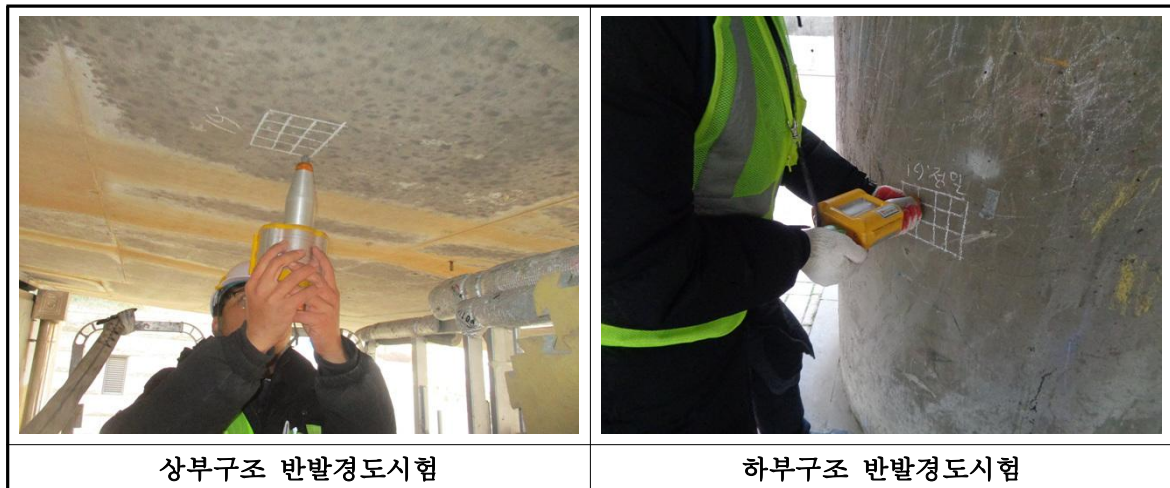
【그림 II-7.3.20】 반발경도 시험 전경
